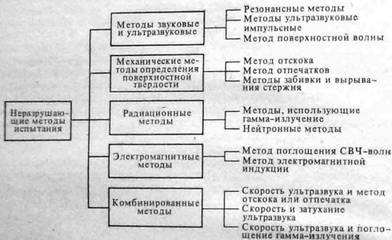
Рис. 5. Неразрушающие методы испытания конструктивных элементов здания
