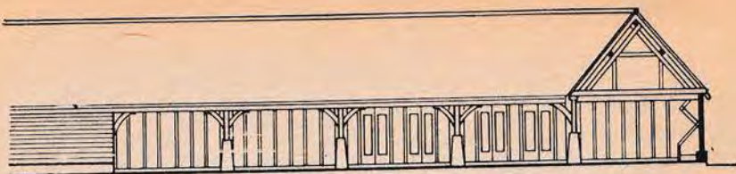
Амбар Лэйнс. Разрез по В—В через крытый переход и помещение для устройства пикников. Фасад остекленной галереи
