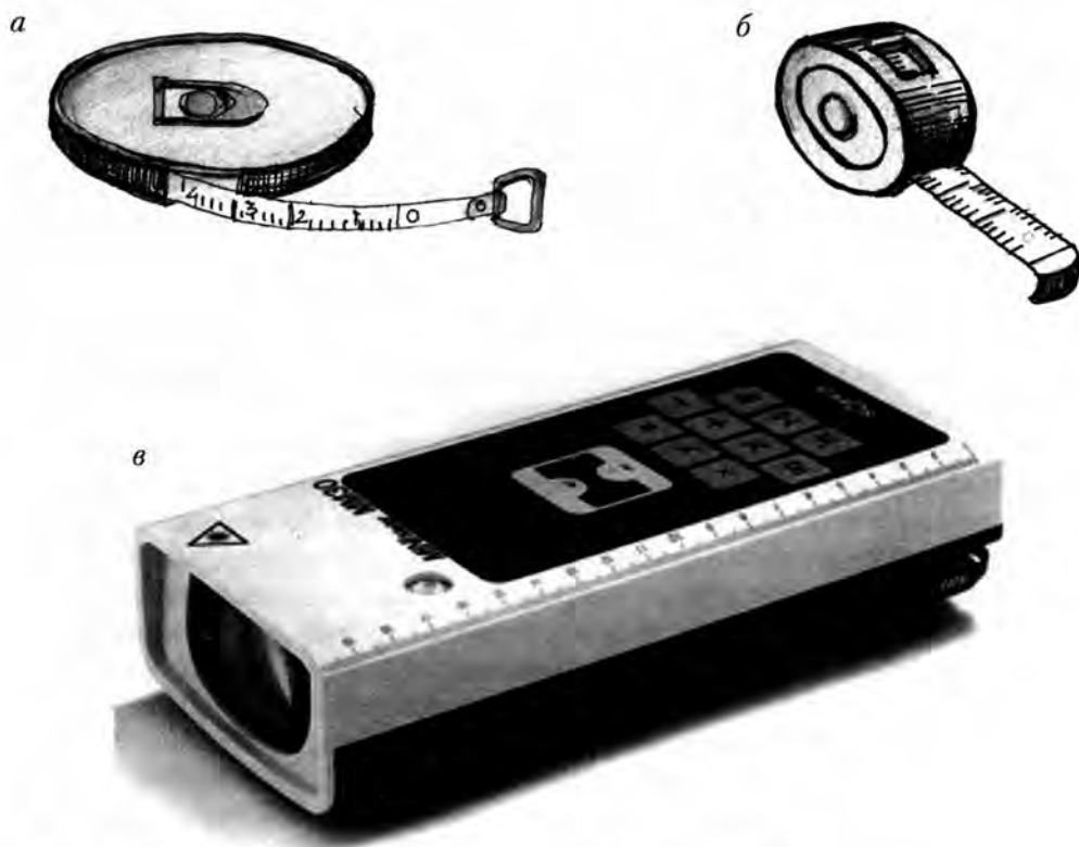
Рис. 6. Рулетки: а — тесьмаяная; б — стальная; в — лазерная
