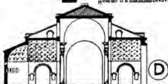
Продольный разрезъ базилики Константина. Поперечный разрезъ базилики Константина.
