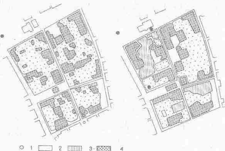
Проектное предложение по функциональному зонированию реконструируемой территории (по А.Э. Гутнову) 1 — выходы из метро; 2 — жилые территории; 3 — гостиницы и общежития; 4 — участки деловых и культурных учреждений
